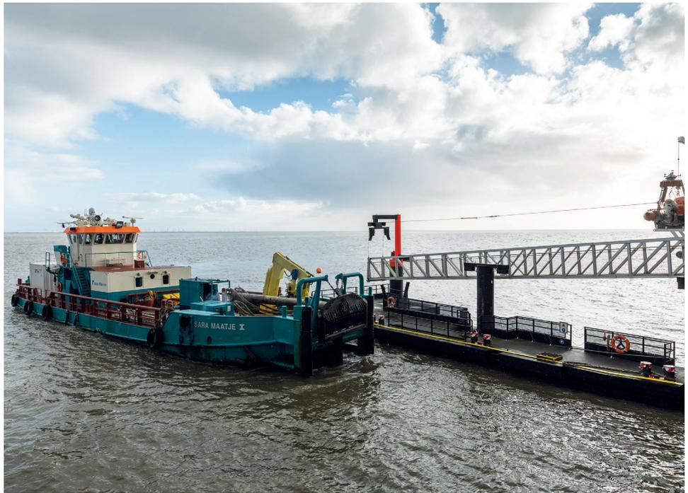
Der auf diese Weise hergestellte und für den Antrieb der Schiffe benötigte Wasserstoff wird in der Landbasis Cuxhaven in einem sogenannten Tanktainer auf die Schiffe gehoben. Aus dem Wasserstoff wird mittels einer Brennstoffzelle Strom erzeugt. Dieser wird in Akkus gespeichert und treibt die Elektromotoren der Schiffe an.
